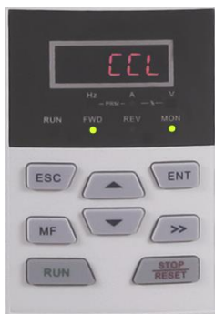
Fig. 4-4 Estado de Visualización de Falla o Alarma (CCL: Falla de Contactor)
